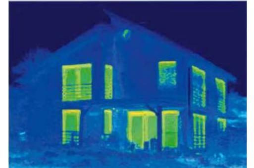
Après l'installation méticuleuse de nouvelles fenêtres du système Schüco LivIng, la thermographie montre les avantages énergétiques de l'investissement. La perte d'énergie initiale est quasiment inexistante.
